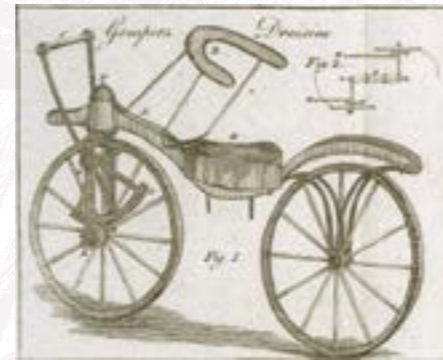
Sogenannte Gomperz-Draisine, vorgestellt in „Dinglers polytechnischem Journal von 1821“ © Preußen-Museum Wesel
